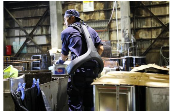
植物油の抜缶作業でパワードウェア ATOUN MODEL Y の活用
