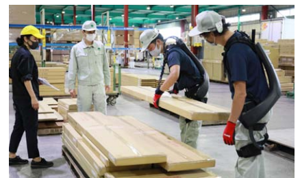
腰に加えて腕の負荷軽減もご検討中。パワードウェア『MODEL Y』にアームアシスト『kote』を加えたデモンストレーション。
